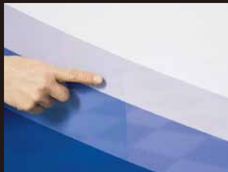
カッティングシートを裏側まで巻き込んで 貼ることでより継ぎ目が目立ちにくくなります
